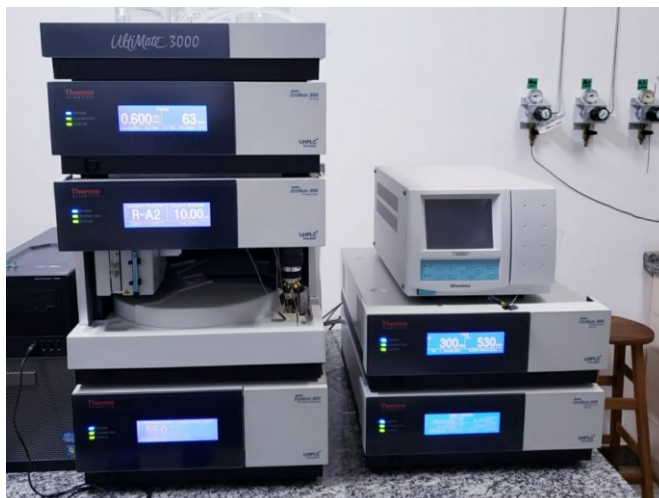
Fotografia 5 - Cromatógrafo utilizado para realizar a análise das amostras
