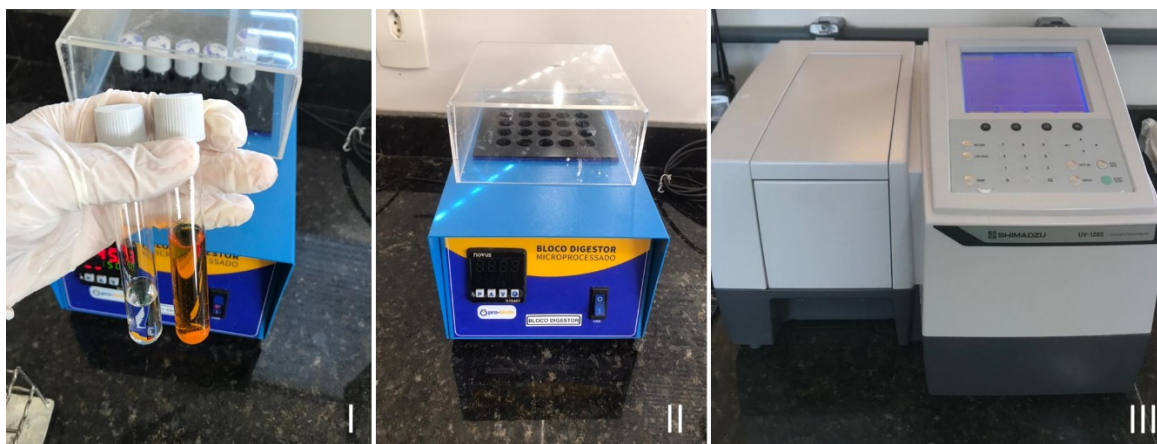
Fotografia 4 - Equipamentos e materiais utilizados para determinação da DQO: I - tubo de ensaio com solução digestora e reagente ácido, II - bloco digestor, III - espectrofotômetro UV-VIS
