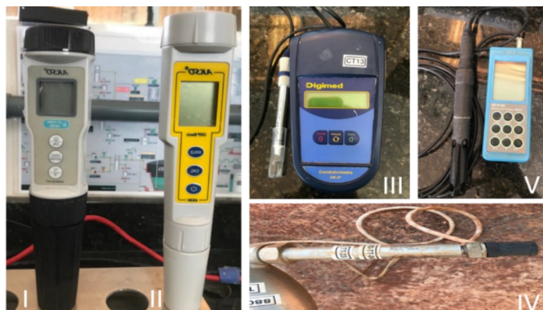
Fotografia 3 - Equipamentos: I - pHmetro, II - medidor de potencial de óxido redução, III - condutivímetro, IV - termômetro digital, V - oxímetro
