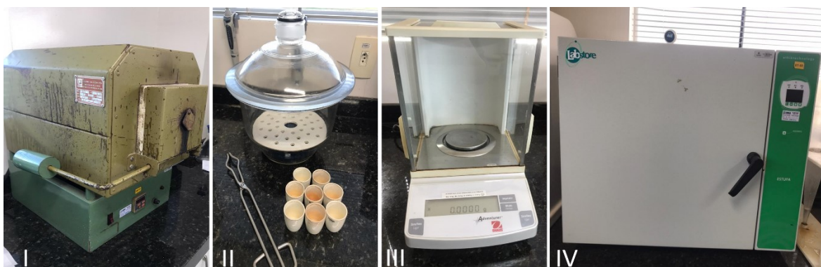
Fotografia 2 - Equipamentos série de sólidos: I - forno mufla, II - dessecador, cadinhos e pinça, III - balança analítica, IV - estufa de circulação de ar forçada
