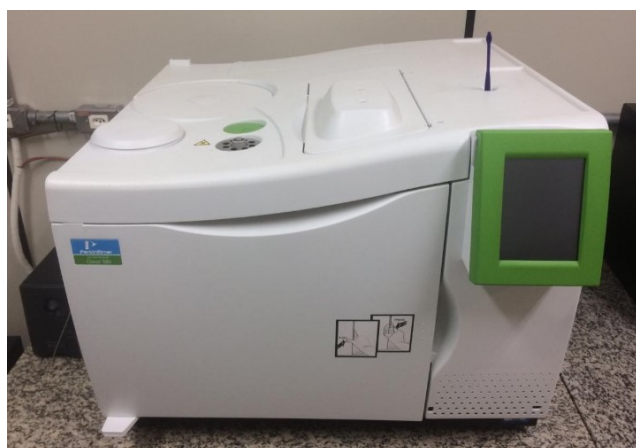
Fotografia 6 - Cromatógrafo utilizado para determinação da composição do biogás
