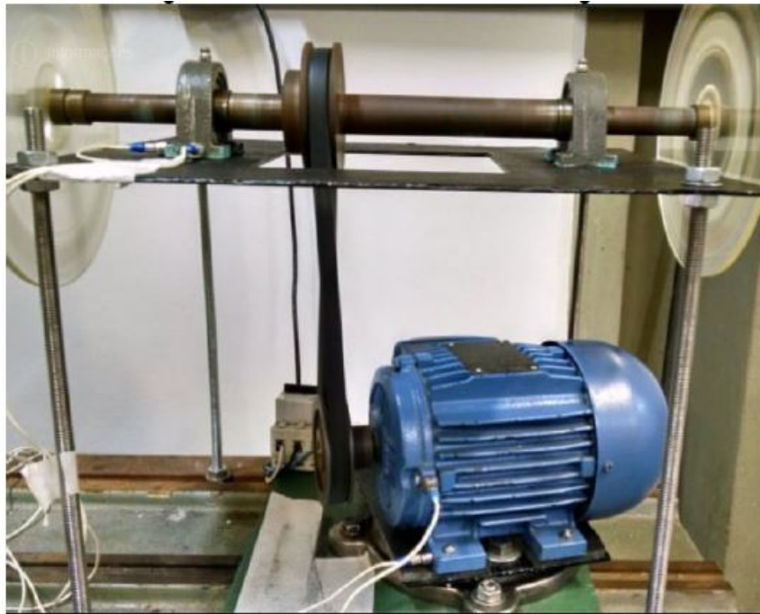
Figura 3 – Bancada didática para simulação de defeitos em correias e polias
