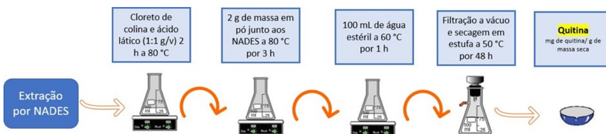
Figura 10 - Desenho esquemático do processo de extração por NADES da quitina.
