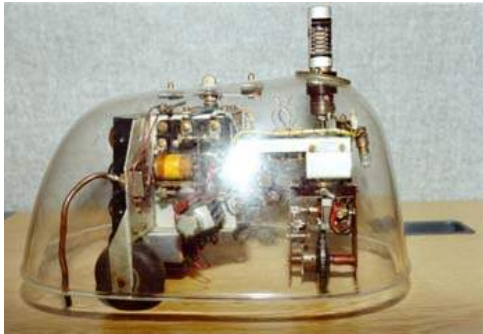
Figura 6 – Elmer e Elsie eram dois robôs com rodas, chamados de cágados (tortoise), que podiam se deslocar pelo chão. Foram desenvolvidos pelo Inglês Grey Walter.
