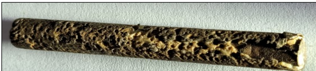
Figura 51 - Corrosão do elemento sensor da sonda STU causado pelo aumento de concentração do inibidor de corrosão na ausência de água de lavagem na tubulação.
