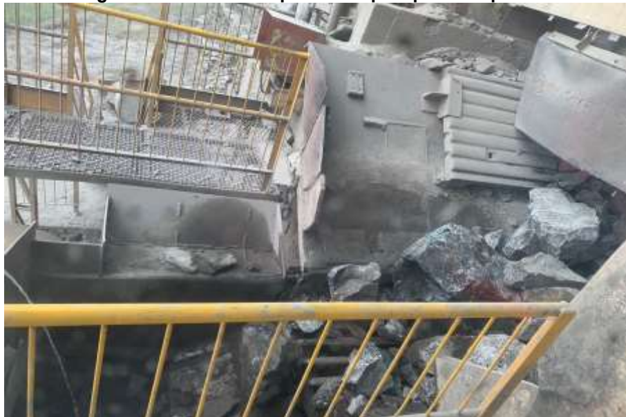
Figura 20. Pedra bruta passando pela primeira peneira
