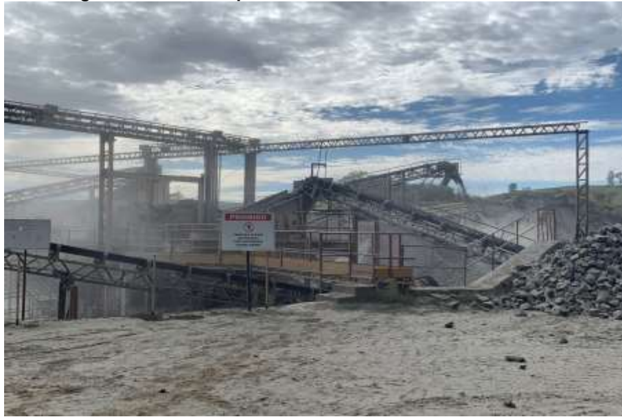
Figura 23. Diversas peneiras e esteiras em funcionamento
