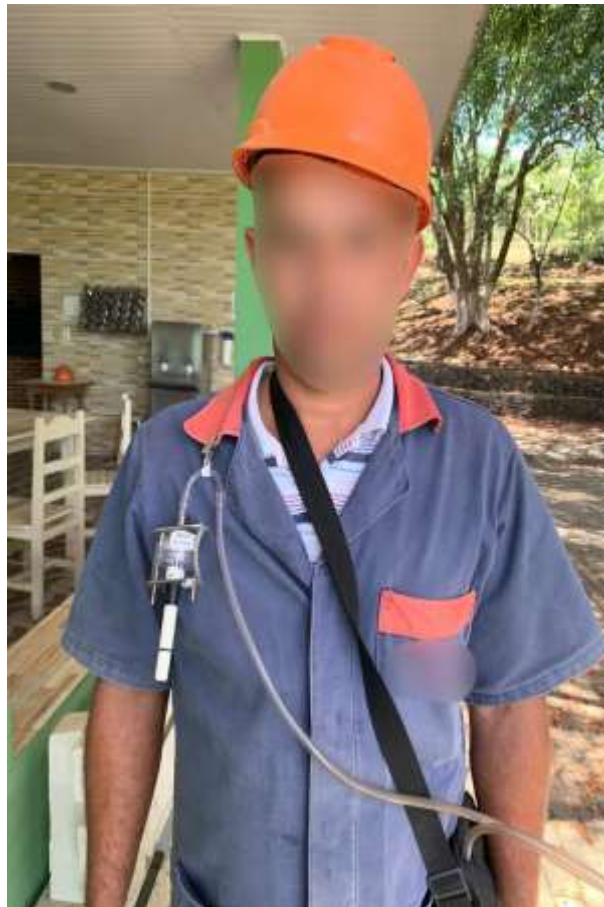
Figura 32. Trabalhador da pedreira com o equipamento colocado para coleta
