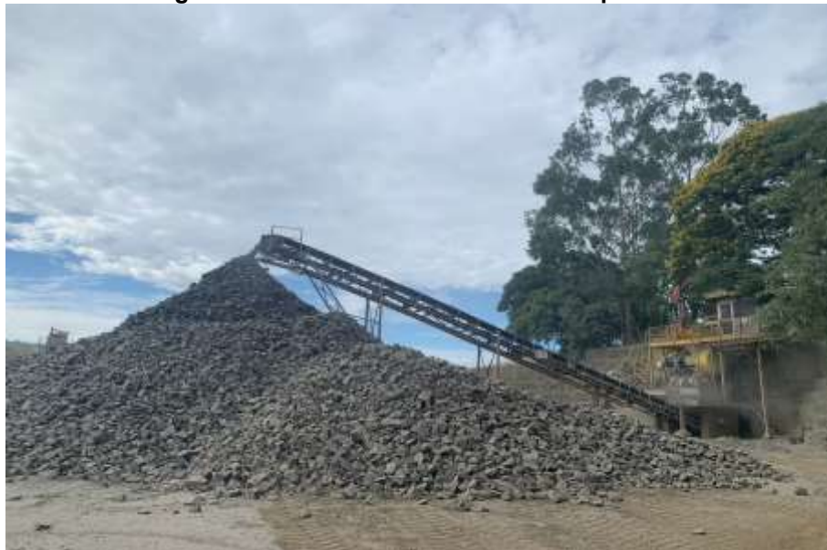
Figura 22. Pedra rachão saindo do maquinário
