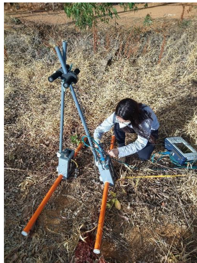
Figura 4 - Fotografias evidenciam a aquisição de dados de GPR na área do Lixão de Alto Paraíso de Goiás. (A) unidade de controle do GPR SIR3000 e as antenas não blindadas de 80 MHz que foram usadas na aquisição de dados do tipo CMP. (B) registro da aquisição de dados do tipo CMP. (C) e (D) registros da aquisição de dados GPR no modo common offset.
