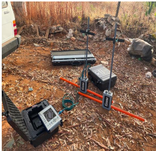
Figura 4 - Fotografias evidenciam a aquisição de dados de GPR na área do Lixão de Alto Paraíso de Goiás. (A) unidade de controle do GPR SIR3000 e as antenas não blindadas de 80 MHz que foram usadas na aquisição de dados do tipo CMP. (B) registro da aquisição de dados do tipo CMP. (C) e (D) registros da aquisição de dados GPR no modo common offset.
