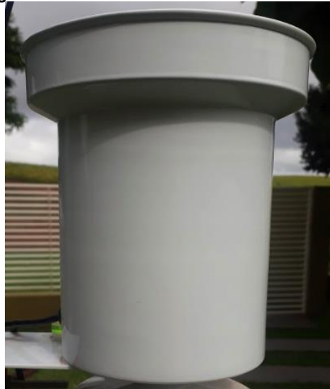
Fotografia 2 - Pluviômetro automático de balança
