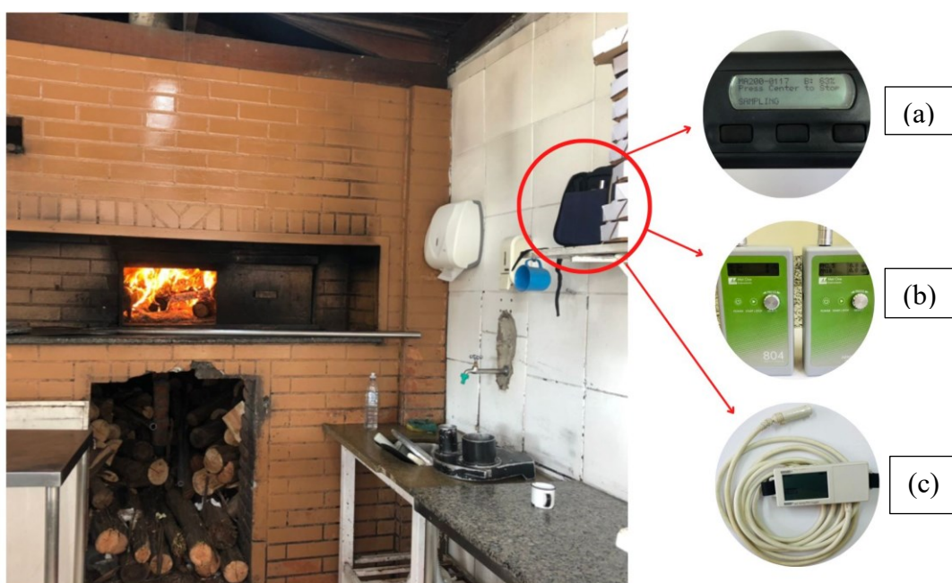
Figura 9 – Equipamentos utilizados nas amostragens: (a) Medidor MicroAeth MA200 para monitoramento de BC no ambiente interno, (b) Met One 804 e Met One 831e (c) Sensor de temperatura e umidade relativa, Onset HOBO UX100-023
