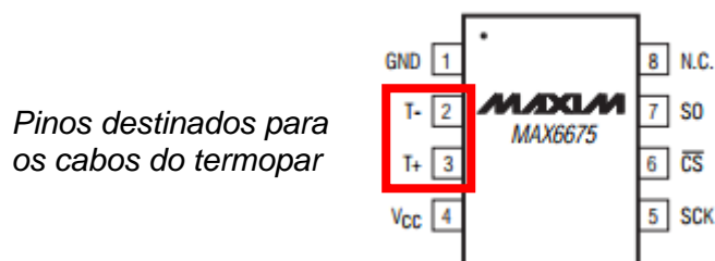
Figura 94 - Detalhes dos pinos do Módulo MAX 6675 Fonte: Adaptado de Maxim (2002).
