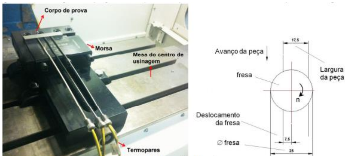
Figura 80 - Detalhe do corpo de prova e termopares utilizado por Barrios (2013)
