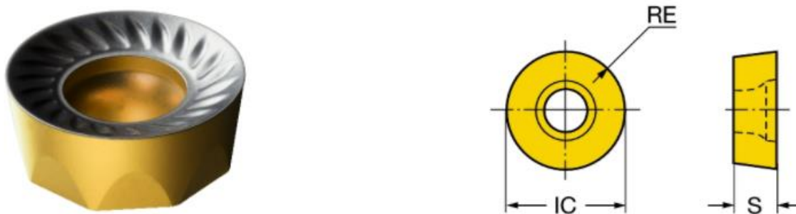
Figura 89 - Inserto de metal duro revestida com cobertura CVD Ti(C,N) - Al_2O_3 - TiN com dimensão IC=12 mm e S=4,76 mm (RCKT 1204 MO PM GC4230) Fonte: Sandvik (2012).
