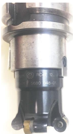
Figura 88 - Fresa de topo coromill 200 para aplicação geral de fresamento com 4 insertos e 50 mm de diâmetro Fonte: Autoria própria.
