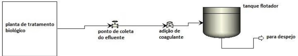
**Figura 4.1 – Esquema simplificado do ponto de coleta do efluente de estudo**
