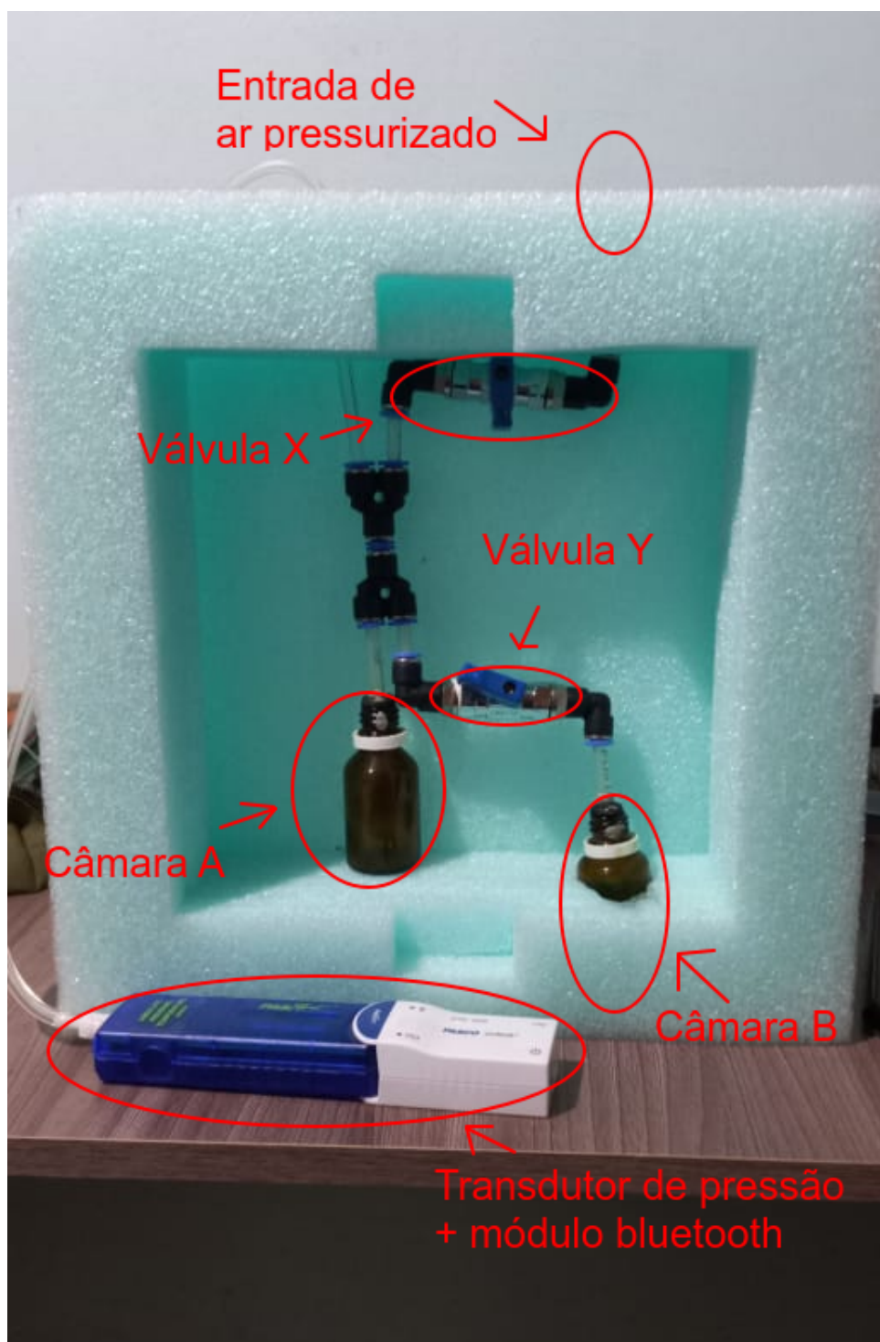
Figura 13 – O picnômetro a gás e seus componentes
