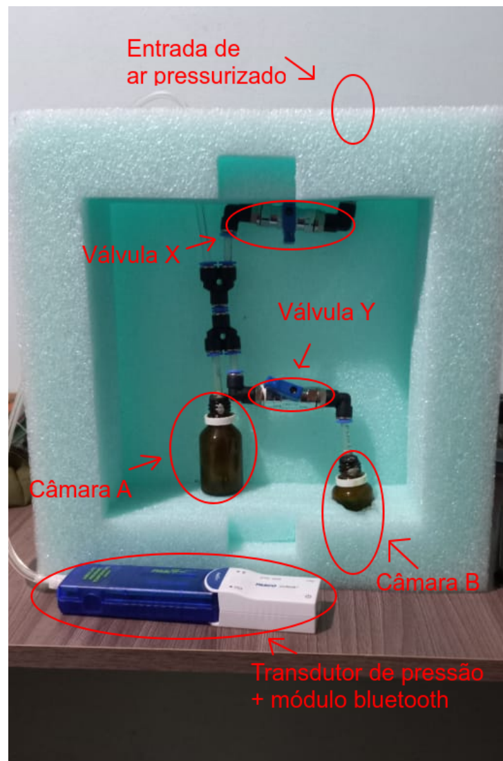
Figura 25 – O picnômetro a gás e seus componentes
