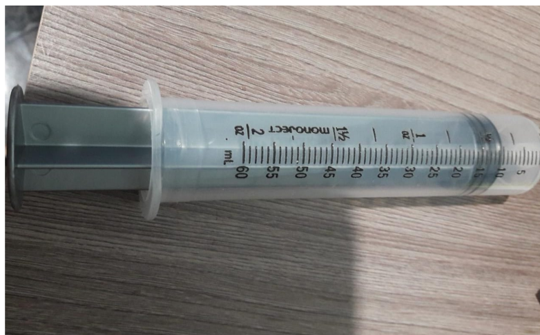
Figura 10 – Seringa utilizada como fonte de pressão
