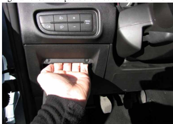
Figura 2.10: Posição do conector OBD no Punto
