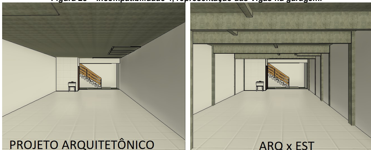
Figura 28 – Incompatibilidade 4, representação das Vigas na garagem.
