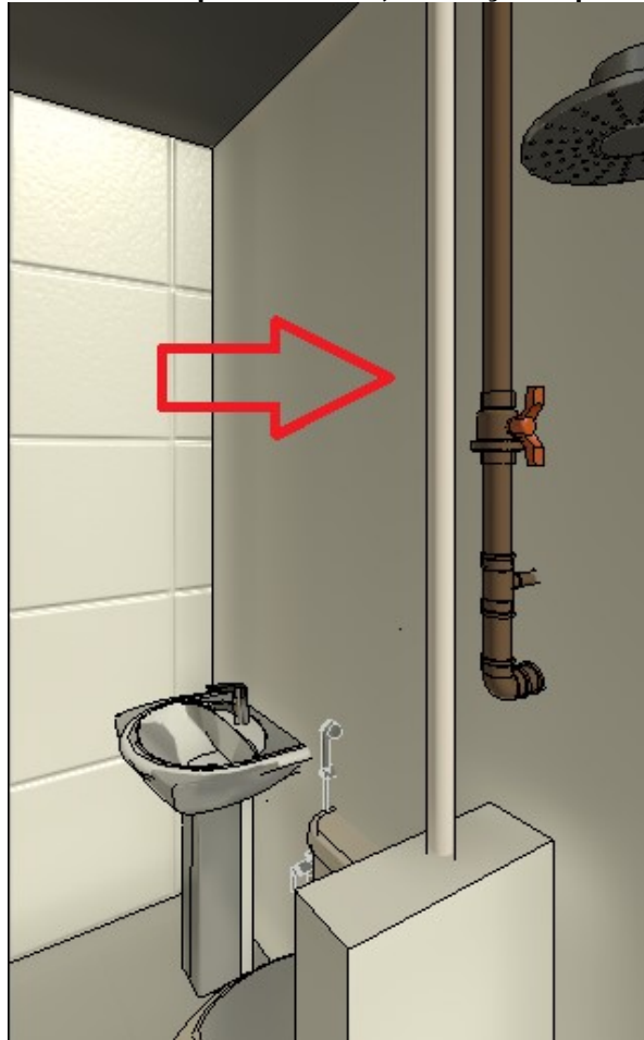
Figura 39 - Incompatibilidade 4, tubulações aparentes.
