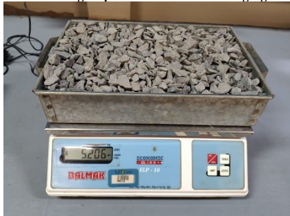
Fotografia 14 – Pesagem para massa unitária do agregado graúdo.
