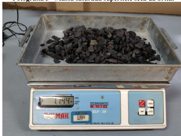
Fotografia 5 - Massa saturada superfície seca da brita.
