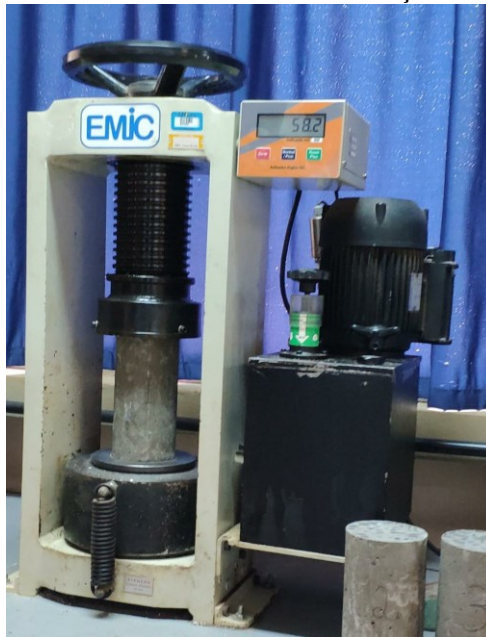
Fotografia 18 - Prensa hidráulica medindo a força do corpo de prova.
