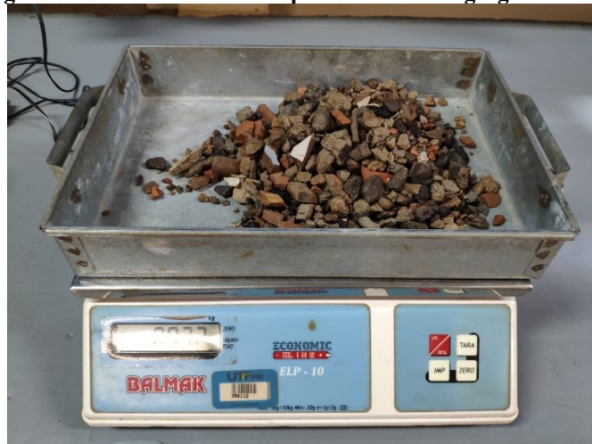
Fotografia 4 - Massa saturada superfície seca do agregado reciclado.
