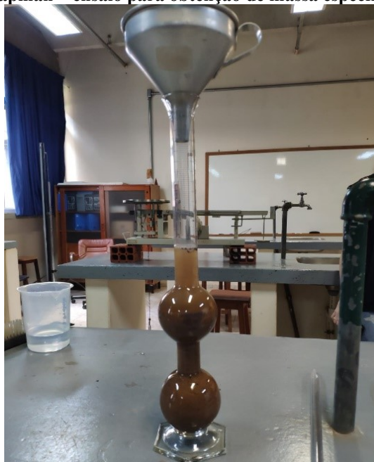
Fotografia 3 - Frasco de Chapman – ensaio para obtenção de massa específica do agregado miúdo.
