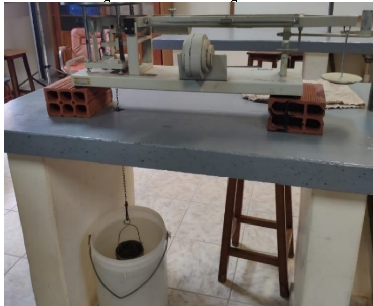
Fotografia 7 – Massa em água da brita.
