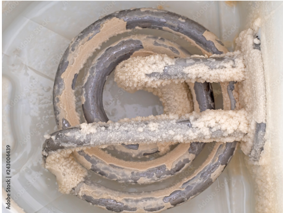
Figura 2 – Formação de depósitos de carbonato de cálcio no interior de uma chaleira elétrica
