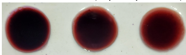
Figura 10 – Otimização - Volume de indicador (esquerda para direita): 200 \mu\text{L} , 150 \mu\text{L} e 100 \mu\text{L}
