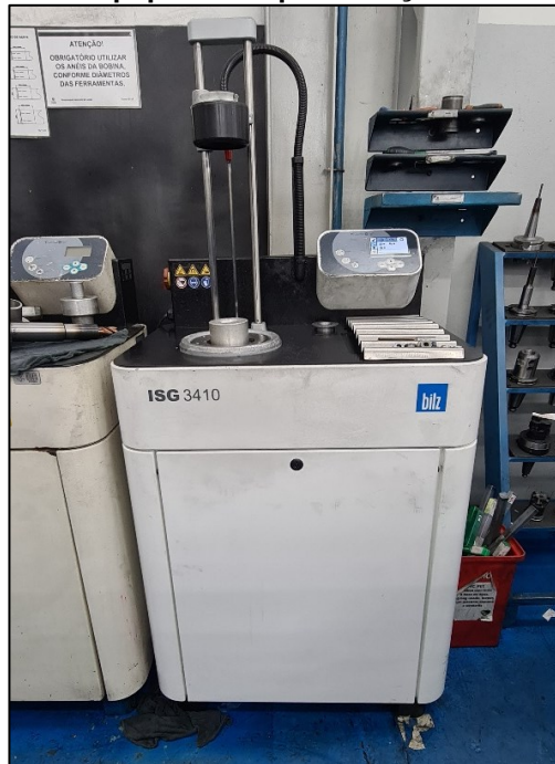
Figura 22 – Equipamento para fixação da ferramenta
