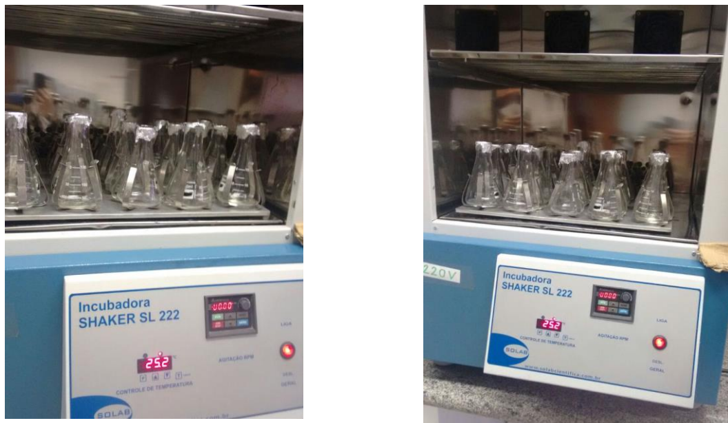
Figura 10 - Incubadora Shaker com os erlenmeyers para ensaios cinéticos
