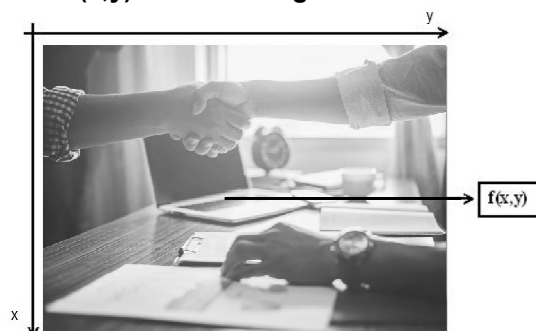
Figura 3 – Conversão utilizada para o par de eixos (x,y) em uma imagem monocromática.
