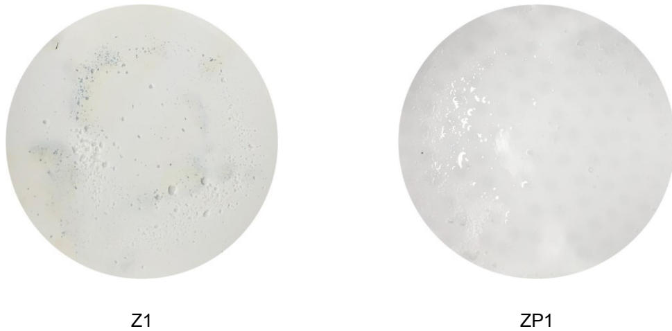
Figura 41 - Membrana de PES funcionalizada com Zeólita Y
