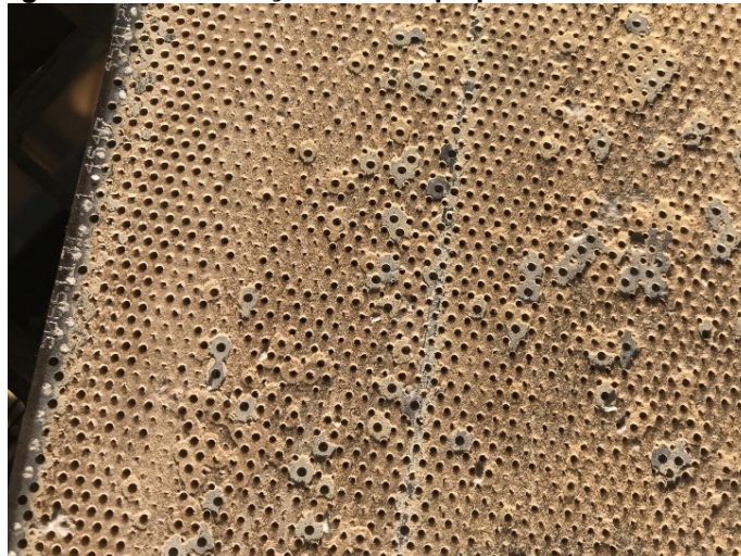
Figura 56 – Incrustações da chapa perfurada do lavador
