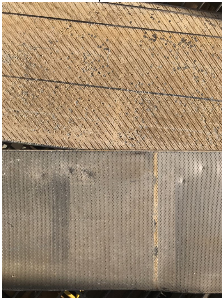
Figura 57 – Diferenças da chapa externa e interna do lavador – ação do chuveiro de alta pressão
