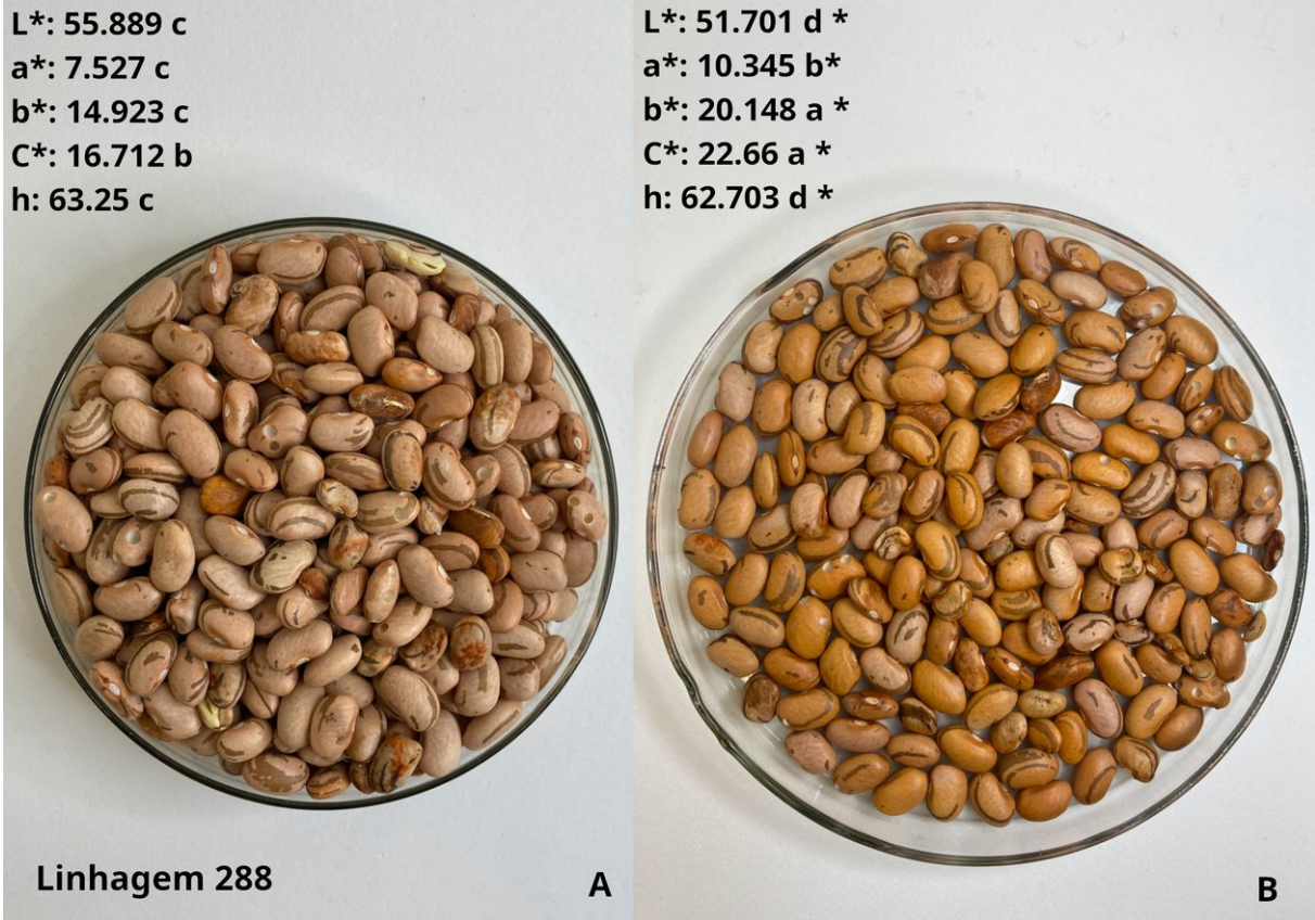
Figura 36 – Variáveis de L*, a*, b*, C* e h da linhagem 288 antes (A) e depois (B) de 72 horas sob luz UV-C
