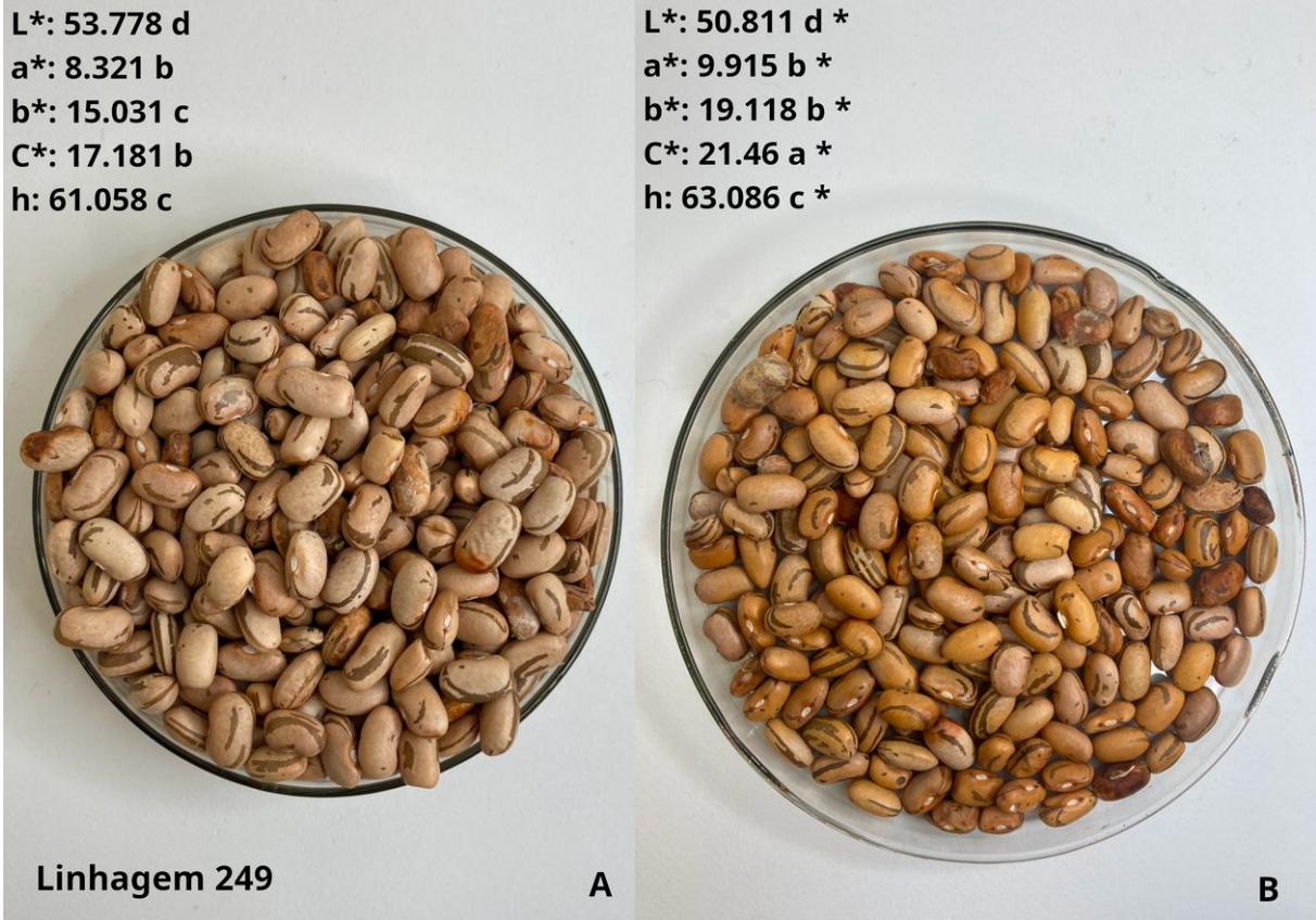
Figura 31 – Variáveis de L*, a*, b*, C* e h da linhagem 249 antes (A) e depois (B) de 72 horas sob luz UV-C
