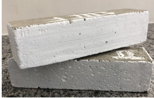
Figura 32 – Corpos de prova com aplicação de tinta epóxi
