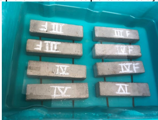
Figura 26 – Corpos de prova imersos em recipiente com solução de sulfato de sódio
