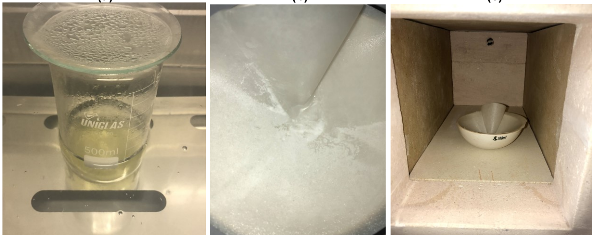
Figura 31 – Etapa de (a) banho-maria, em (b) material retido pós filtração (c) material na mufla
