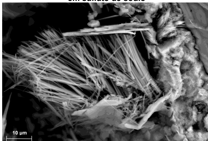
Figura 61 – Imagem ampliada 3000x por MEV para a amostra T040F após 15 meses de imersão em sulfato de sódio
