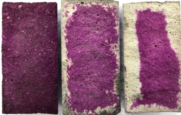
Figura 72 – Evolução da frente de carbonatação para a/c 0,40, a/c 0,55 e a/c 0,70
