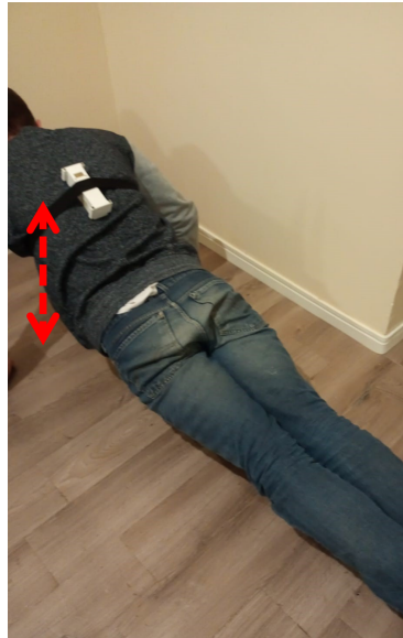
Figura 50 – Fixação do sensor para os testes de flexão (nas costas) e a indicação do movimento
