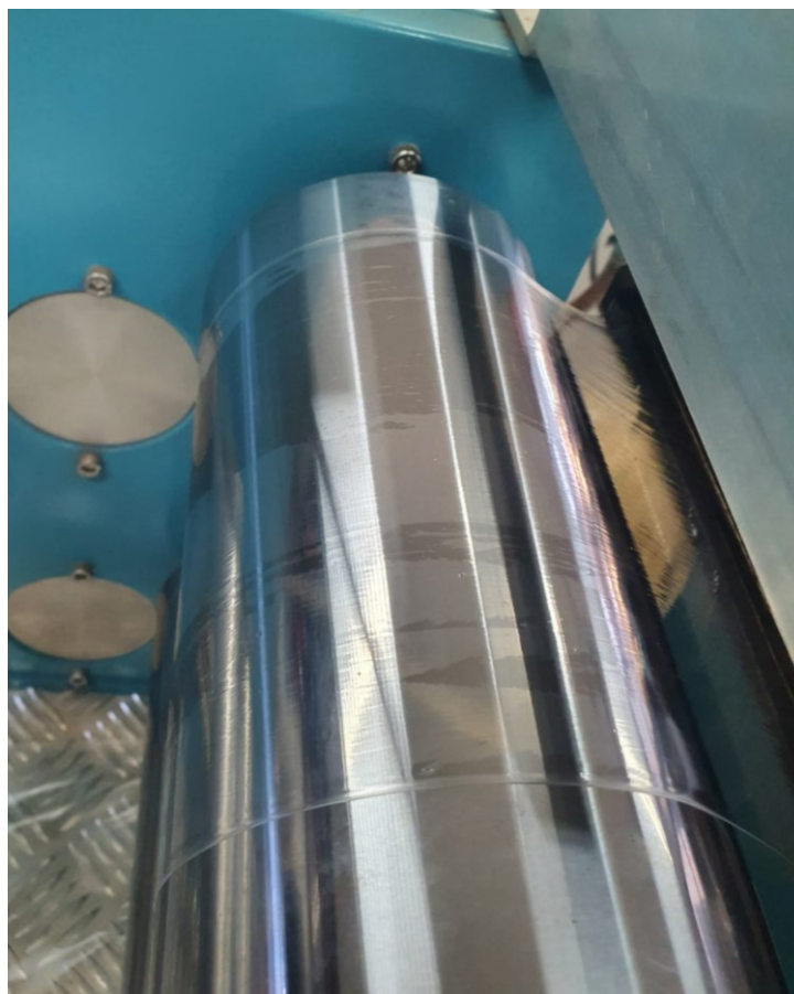
Figura 25 - Manchas de aspecto “molhado” logo após a saída do material da matriz.
