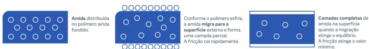
Figura 6 - Difusão da amida para a superfície ao longo do tempo.
