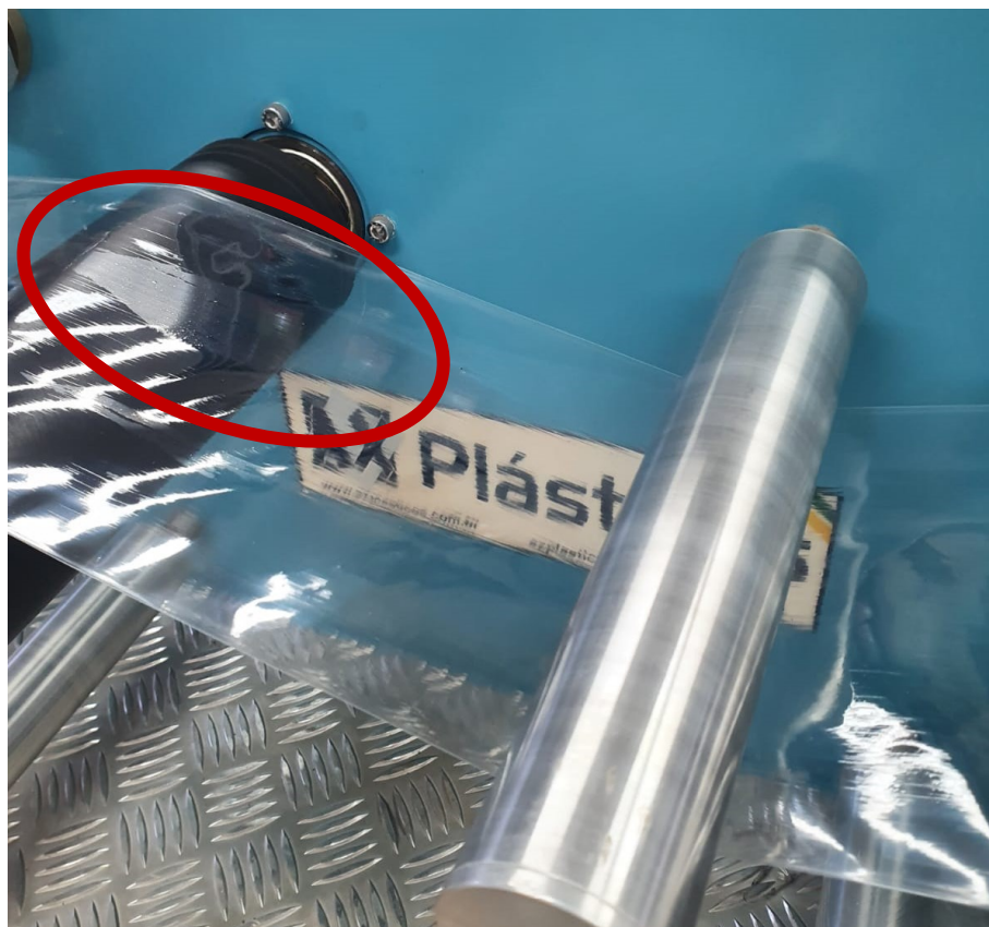
Figura 26 - Manchas com aspecto "molhado" ao longo do embobinamento do filme.
