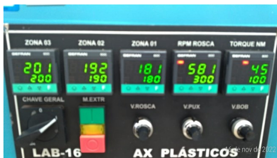
Figura 18 - Temperaturas configuradas e reais em cada zona do perfil de 190°C.
