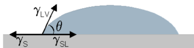
Figura 8 - Definição do ângulo de contato entre uma gota líquida e uma superfície plana e horizontal.
