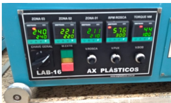
Figura 19 - Temperaturas configuradas e reais em cada zona do perfil de 220°C.
