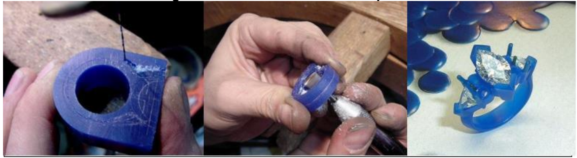
Figura 5: Processo de modelagem manual. Processo de esculpir a resina manualmente.
