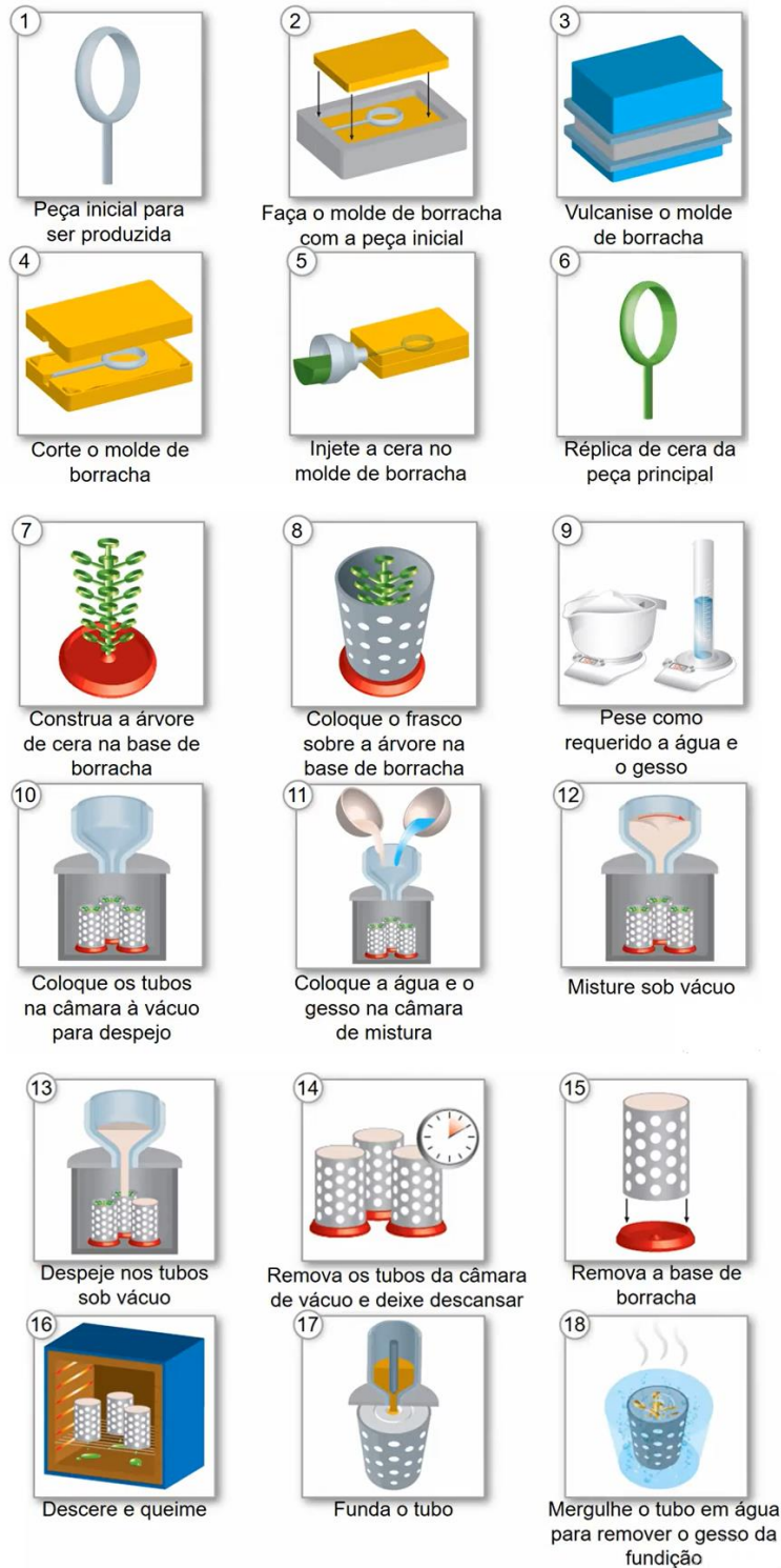
Figura 3: Fluxograma do processo de fundição por cera perdida em etapas.
