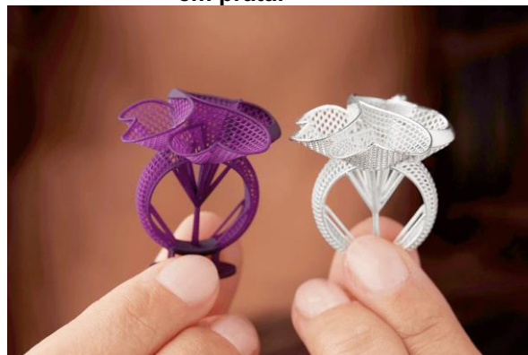
Figura 4: Fidelidade impressão 3D. Peça na cor roxa feita por impressão 3D e peça finalizada em prata.
