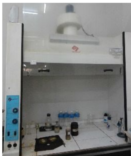
Figura 9 – Capela para exaustão de gases Quimis
