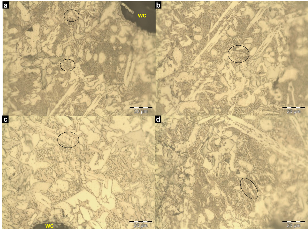
Figura 50 – Imagem de MO da seção transversal do revestimento NiCrBSi-WC (12.5) (aumento 1000x)
