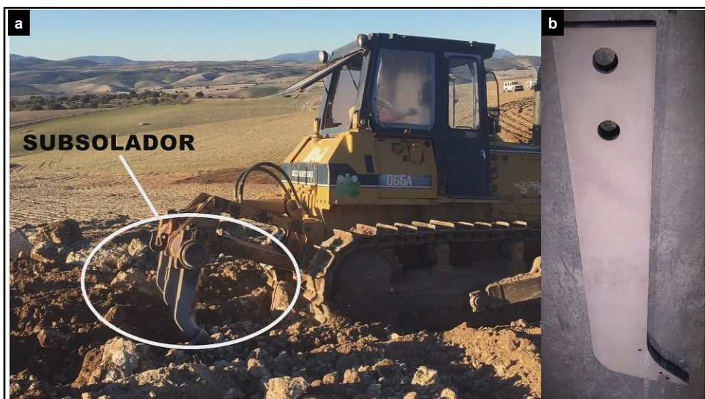
Figura 16 – Subsolador em funcionamento (A) e detalhe do subsolador (B)
