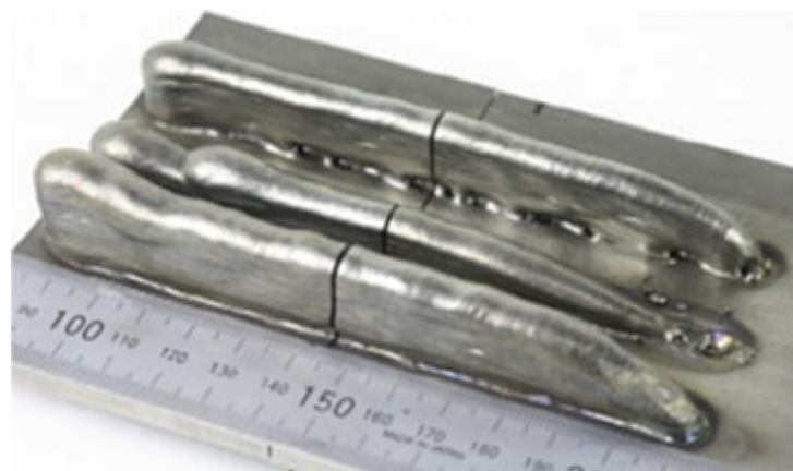
Figura 15 – Irregularidades resultantes da sobreposição de cordões de solda: o início de cada cordão (à direita) apresentando falta de material enquanto a porção final (à esquerda) apresenta excesso.
