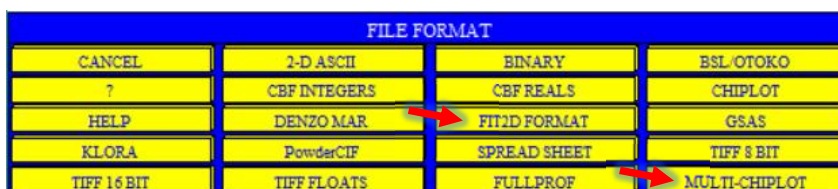
Figura 147 – Trecho da tela do software fit2d para armazenar o resultado obtido na saída da integração.
