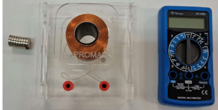
Figura 14 - Aparato experimental do experimento de Faraday
