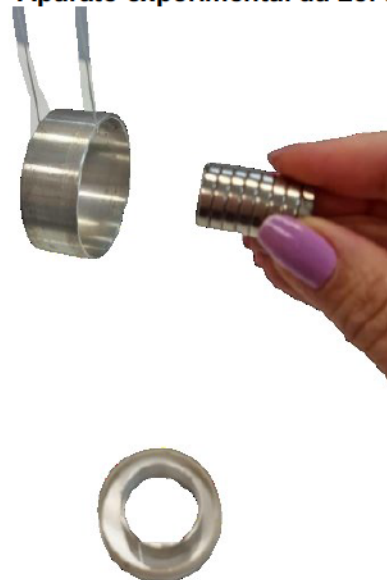
Figura 10 - Aparato experimental da Lei de Lenz
