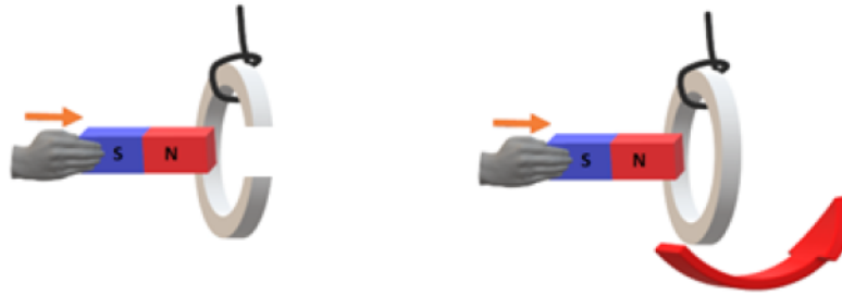
Figura 19 - Experimento anel de Lenz
