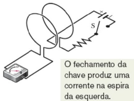
Figura 4- Representação semelhante do experimento realizado por Faraday
