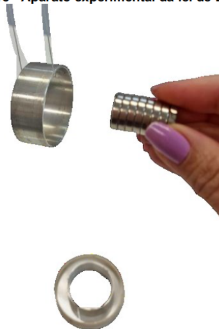
Figura 15 - Aparato experimental da lei de Lenz
