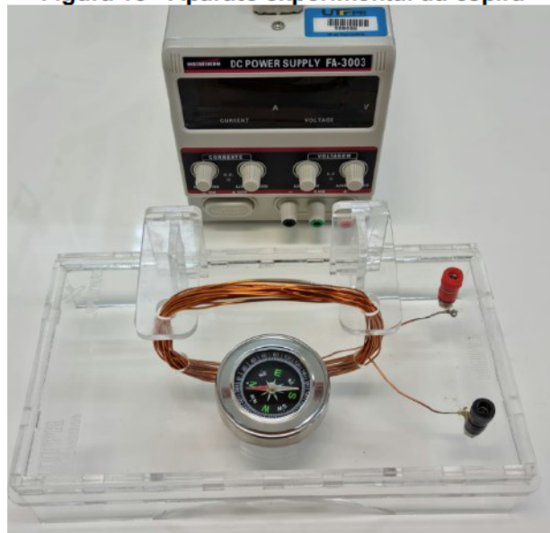
Figura 13 - Aparato experimental da espira
