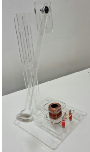
Figura 13 - Representação do Experimento Pêndulo eletromagnético
