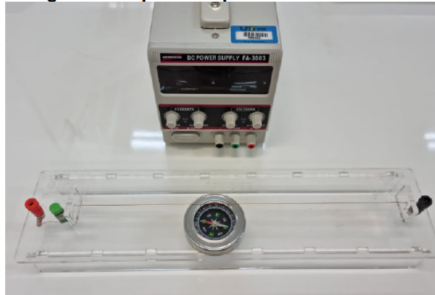
Figura 12 - Aparato experimental de Oersted
