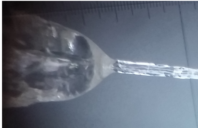
Figura 32: Foto da fixação da DCF na corneta utilizando super cola visto por um microscópio ocular.
