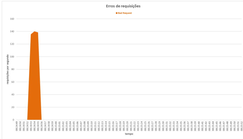
Figura 26 – Erros de requisições ocorridos no servidor primário durante ataque FIN Only Set com sensor Gaussian Naive Bayes
