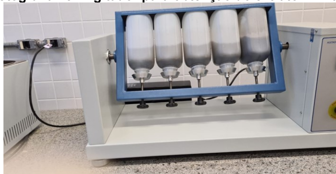
Fotografia 15 - Agitador para obtenção do extrato lixiviado
