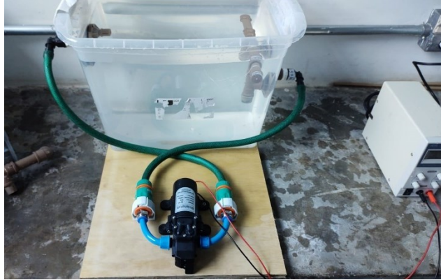
Fotografia 13 - Aparelho usado para lixiviação de monolitos
