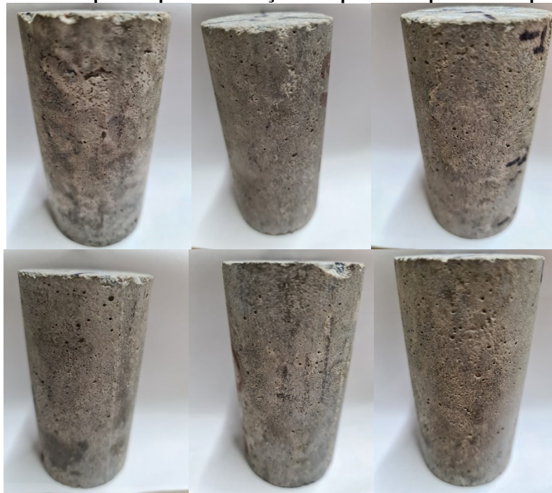
Fotografia 26 - Corpos de prova do traço T10 após o ataque interno por sulfatos
