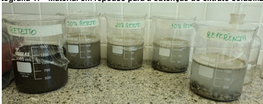
Fotografia 17 - Material em repouso para a obtenção do extrato solubilizado
