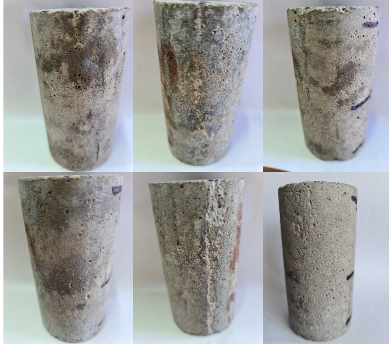
Fotografia 28 - Corpos de prova do traço T30 após o ataque interno por sulfatos
