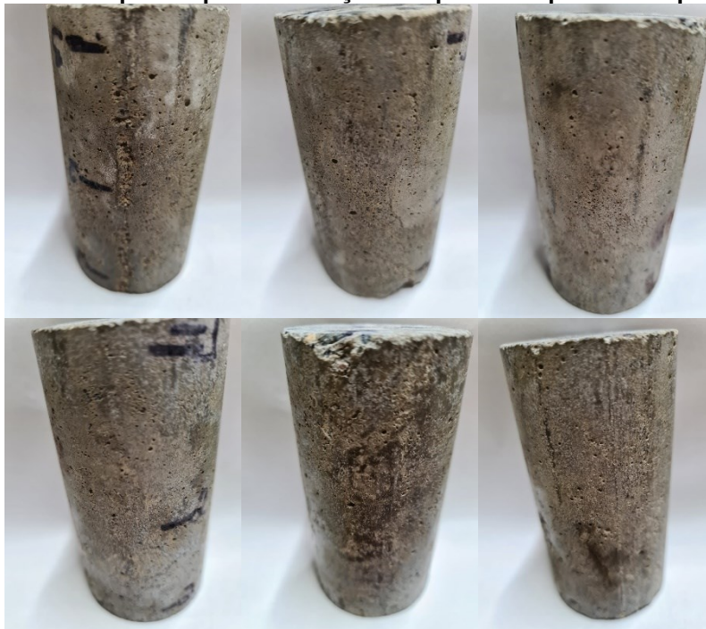
Fotografia 27 - Corpos de prova do traço T20 após o ataque interno por sulfatos
