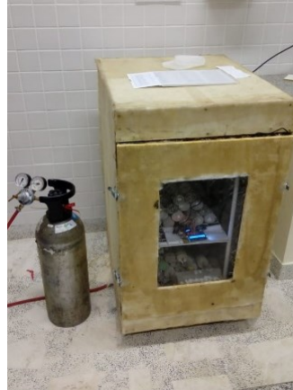
Fotografia 10 - Câmara de carbonatação
