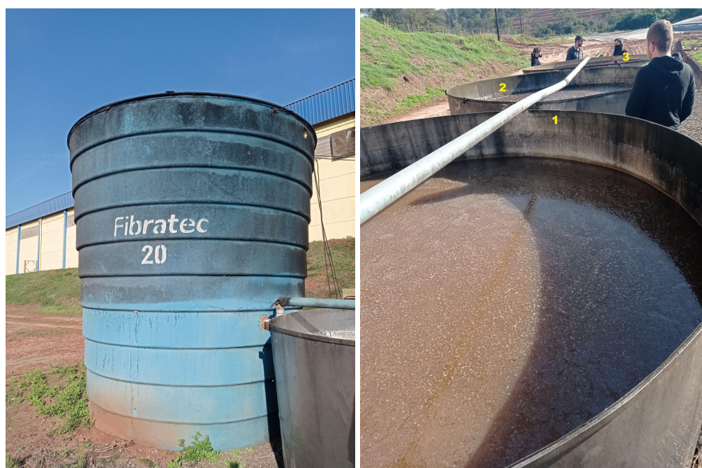
Figura 6. Tanques de tratamento do cianeto presente na manipueira da área em estudo.
