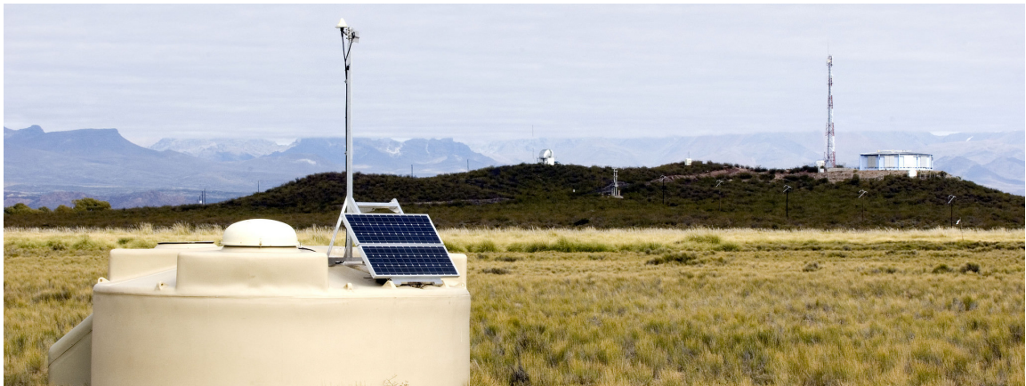
Figura 4 – Detector de superfície e ao fundo, a direita, um dos prédios que abrigam os telescópios de fluorescência no Observatório Pierre Auger.
