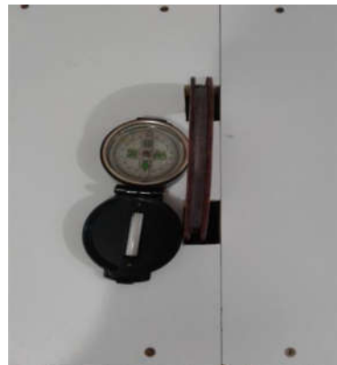
Figura 8 – Bobina e bússola posicionada em paralelo
