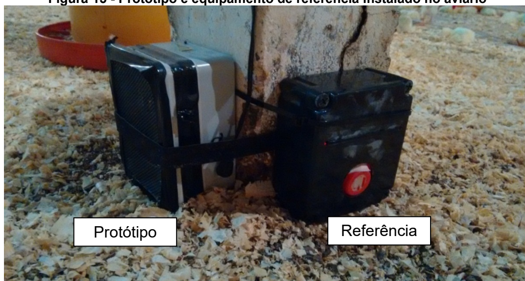
Figura 15 - Protótipo e equipamento de referência instalado no aviário
