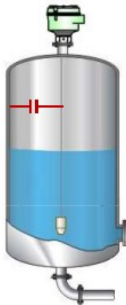
Figura 3 - Medição de Nível por Método Indireto (Sensor Capacitivo)
