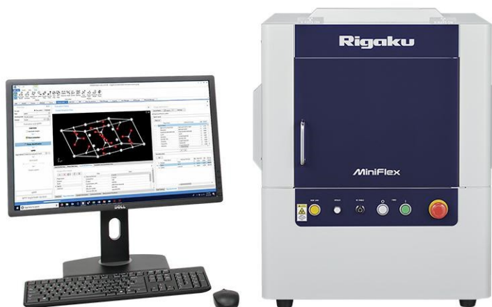
Figura 4 - Equipamento de DRX, modelo Miniflex 600, da marca Rigaku
