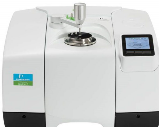
Figura 3 - Equipamento de FTIR-MIR, modelo Frontier, da Perkin Elmer
