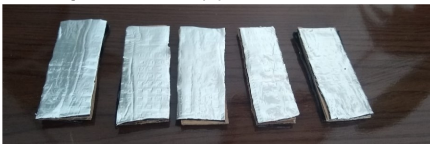
Figura 7 - Amostras de papelão com manta asfáltica
