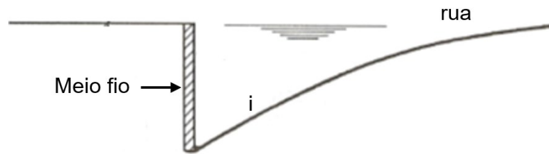
Figura 3 - Esquema usual de uma sarjeta
