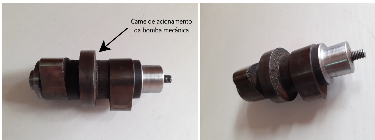
Figura 26 - Eixo de cames fabricado para o projeto
