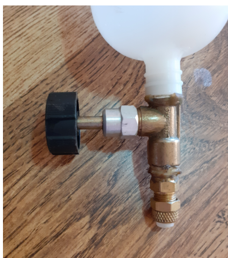
Figura 35 - Válvula para controle da vazão de saída de combustível
