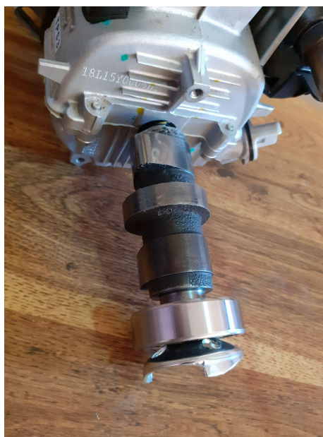
Figura 28 - Eixo de cames acoplado ao motor
