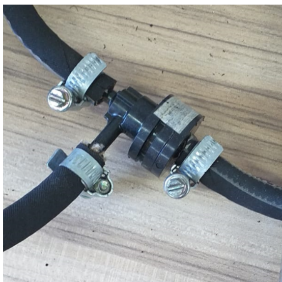
Figura 16 - Regulador de pressão do sistema de injeção de combustível atual
