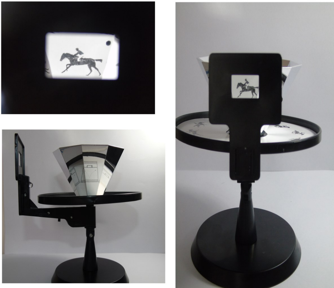
Figura 49 - Divisão para observar as partes da animação com o aparelho óptico praxinoscópico
