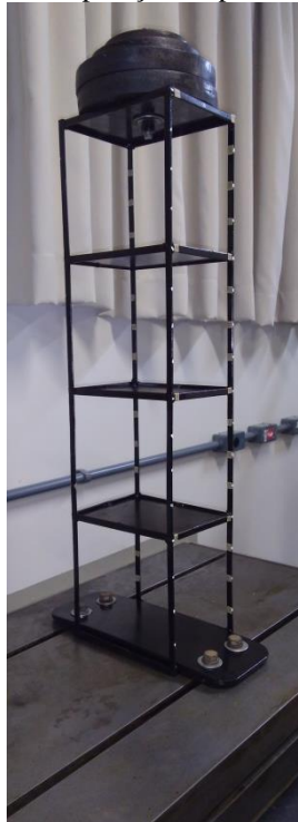
Figura 25 - Preparação do pórtico soldado.
