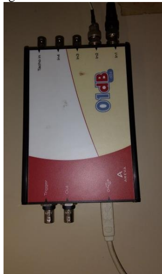
Figura 32 - Analisador de sinais.
