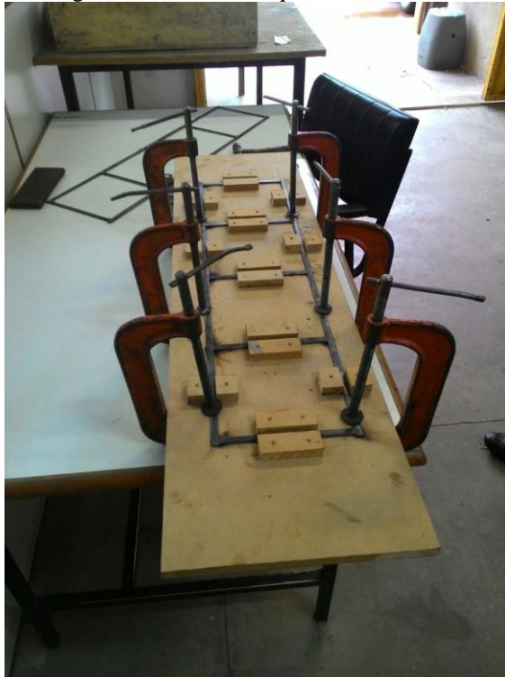
Figura 22 - Garantia esquadro da estrutura.
