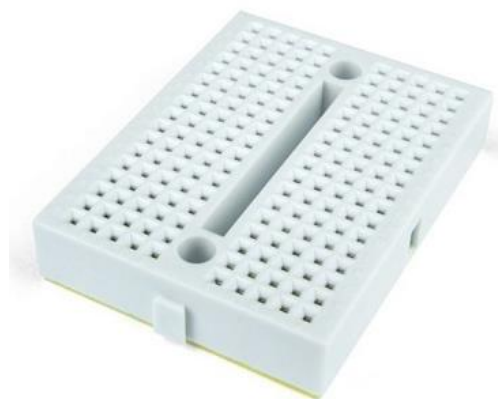
Figura 20 - Protoboard utilizada para conexão do conjunto
