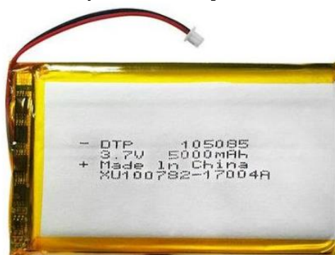
Figura 14 – Bateria para alimentação do sistema
