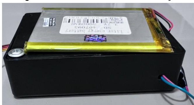
Figura 25 – Saída dos cabos de alimentação
