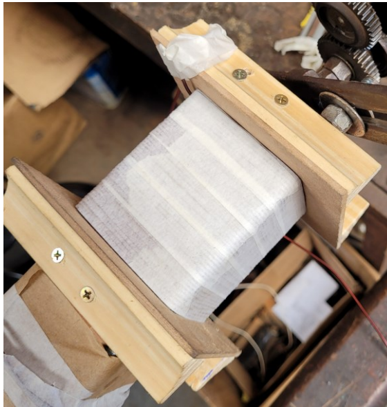
Figura 14 - Enrolamento primário finalizado
