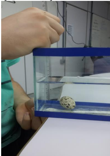
Figura 10. Verificação da elevação de nível causada pelo ovo de codorna
