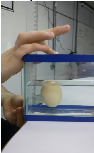
Figura 11. Verificação da elevação de nível causada pelo ovo de galinha
