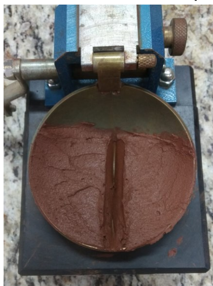
Figura 22 – Fechamento da ranhura após golpes
