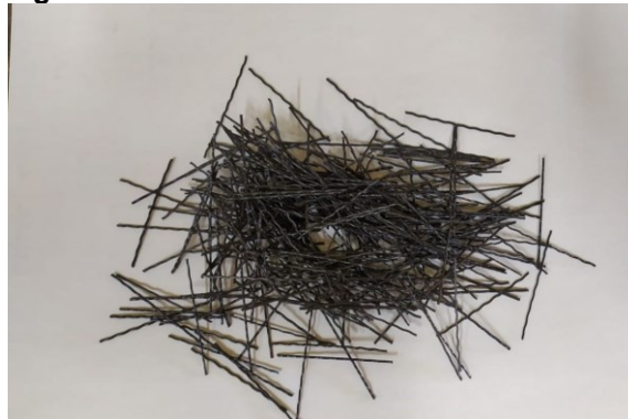
Figura 5 - Macrofibra Estrutural Sintética MM.
