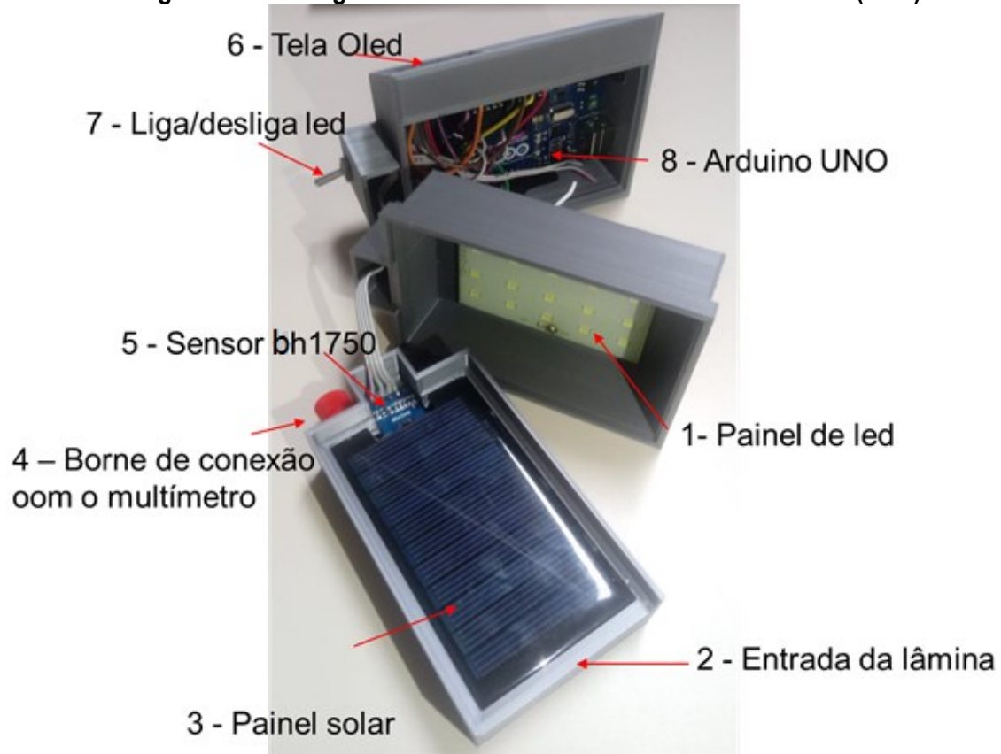
Figura 11 - Montagem do Sistema de Análise de Contaminantes (SAC)
